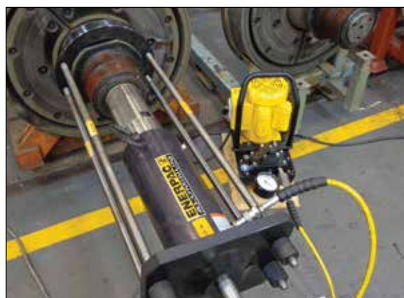
◀ Arrastre de ruedas de riel con cilindro de aluminio RACH accionado por bomba de la serie ZE.
