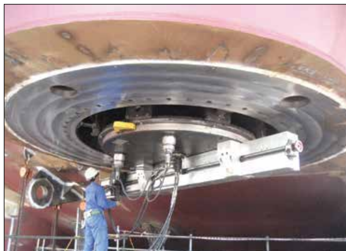
▼ Fresado de brida de la hélice de arranque de un barco.
