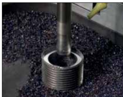
▲ Ahuecamiento del centro de un perno pequeño diámetro.
