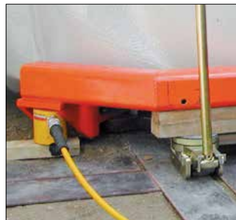
▼ Transporte de tanque para productos químicos: Para las primeras pulgadas la carga se elevó con un cilindro de baja altura de la serie RCS y luego se movió a patines de carga para su transportación.
