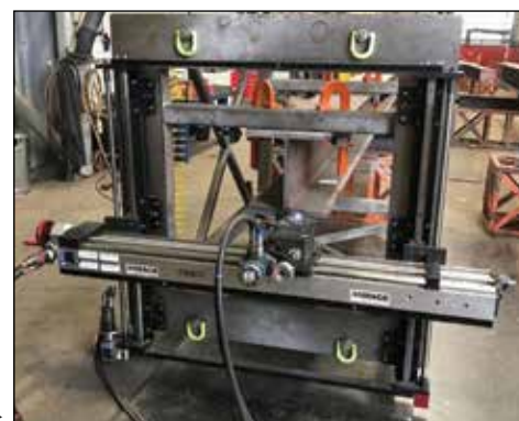
Fresado de la cara final de una viga en I con una GMRF1000. ▶
