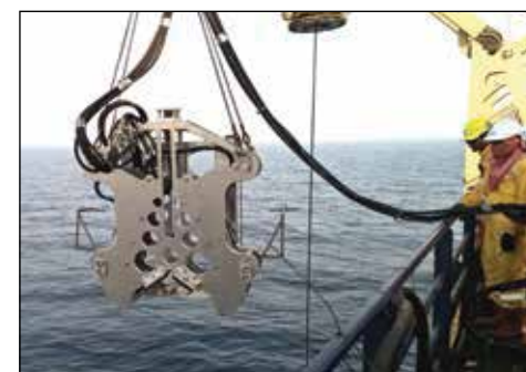
▲ Descenso al mar de una sierra con alambre de acero adiamantado.
