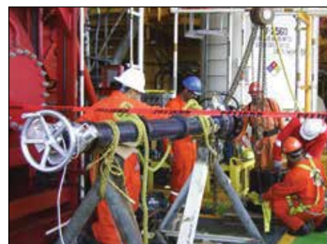
▼ Roscado en servicio de la CHT2000 en una aplicación mar afuera.
