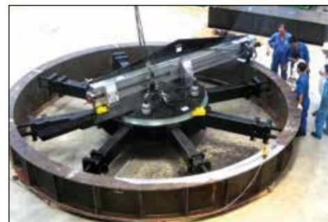
▼ Maquinado de cara de cojinete de grúa.
