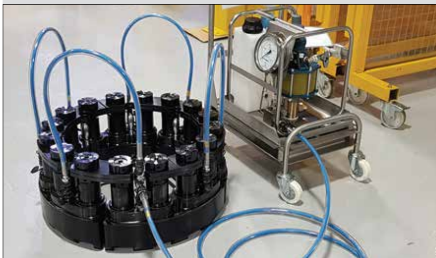
▲ Disposición del tensado de múltiples tornillos.
