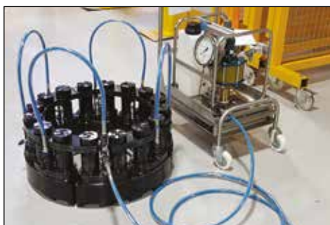
◀ El sistema de tensionado multiespárrago (MST) de Enerpac es capaz de tensionar todos los espárragos de una junta simultáneamente.
