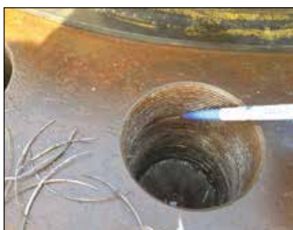
▲ Una rosca típica antes de la reparación
