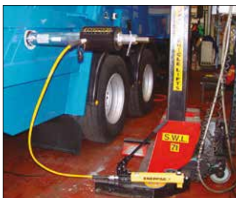
◀ Un cilindro RACH306 alimentado por una bomba de mano ligera P392 utilizado para extraer pernos corroídos de vehículos de recogida de basura.
