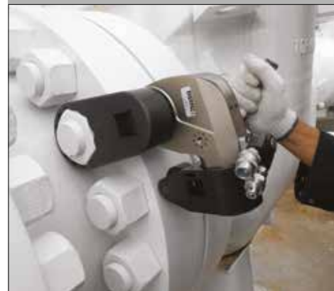
▲ Llave dinamométrica S11000X personalizada con conexión de par de apriete y rodillo de reacción personalizados.
