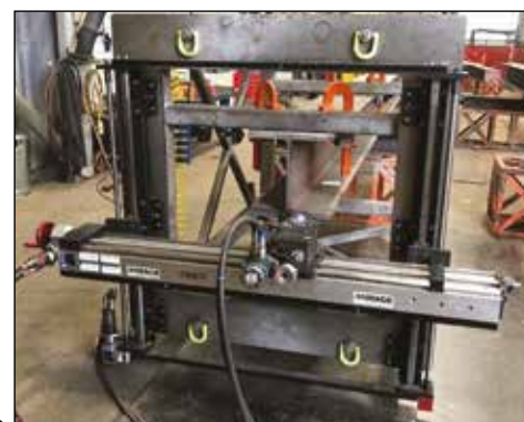
Fresado de cara final de viga I con una GMRF1000. ►
