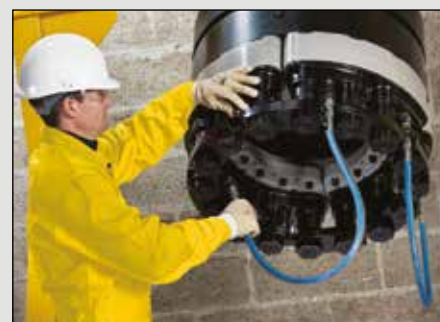
▲ Aplicación de tensionado multiespárrago.
