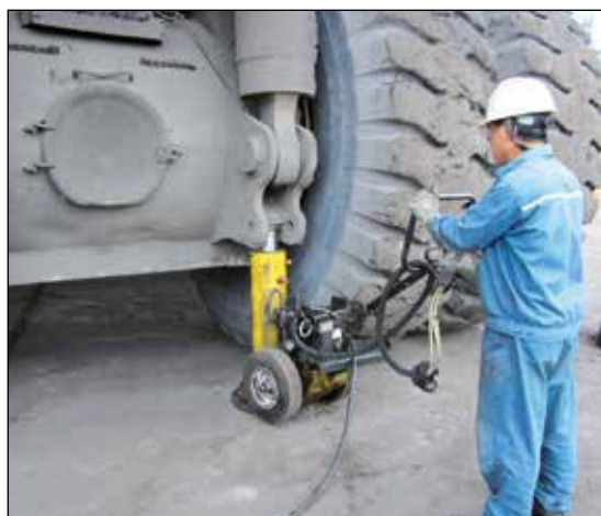
◀ Enerpac POW'R-RISER® de Enerpac utilizado en la minería para levantar equipos pesados.
