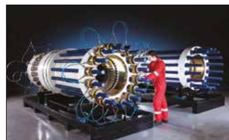
▲ Los tensores submarinos de Enerpac interconectados con mangueras de la serie HT aplican una carga uniforme en los pernos.
