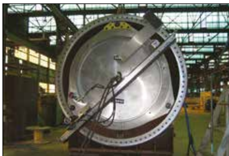
▼ Mecanizado de torre eólica con WP4600.
