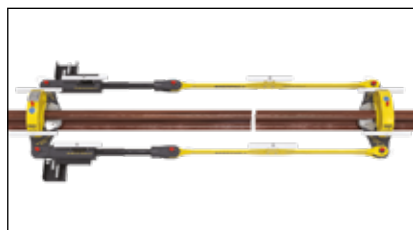
▲ Tensor modular de 70 toneladas que mantiene el riel en longitud neutra durante el proceso de soldadura.
